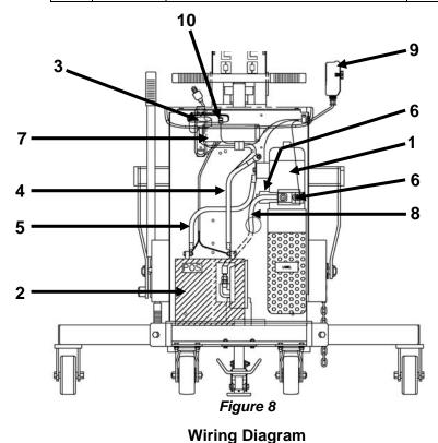
PENDANT SWITCH ON/OFF SWITCH DOWN SOLENOID UP Fo LQ. 12 VOLT, 10 AMP CHARGER TO MOTOR BLACK 101 WHITE MOTOR STARTER POWER CORD 120 VOLT RED YELLOW BLACK BATTERY
