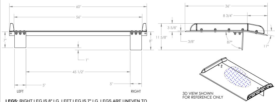
LEGS: RIGHT LEG IS 8" LG, LEFT LEG IS 7" LG. LEGS ARE UNEVEN TO CREATE A GAP SO DOCKBOARD CAN BE PICKED UP BY A FORK LIFT
