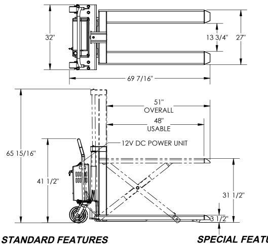
MODEL NUMBER IS HIPM-2748-DC **OVERALL WIDTH IS 32" OVERALL LENGTH IS 69 7/16" OVERALL LOWERED HEIGHT IS 41 1/2"** OVERALL RAISE HEIGHT IS 65 15/16" FORK WIDTH IS 27' **USABLE FORK LENGTH IS 48"** LOWERED FORK HEIGHT IS 3 1/2" RAISED FORK HEIGHT IS 31 1/2" MAX CAPACITY IS 2500 LBS. FOR USE WITH OPEN BOTTOM SKIDS ONLY POWER SPECIFICATIONS: DC 12V WITH HAND HELD PENDANT CONTROL. INCLUDES AN ON **BOARD BATTERY CHARGER**
